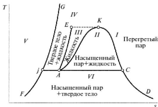
Рис. 2.8. Фазовое состояние для воды и водяного пара на T, s -диаграмме
