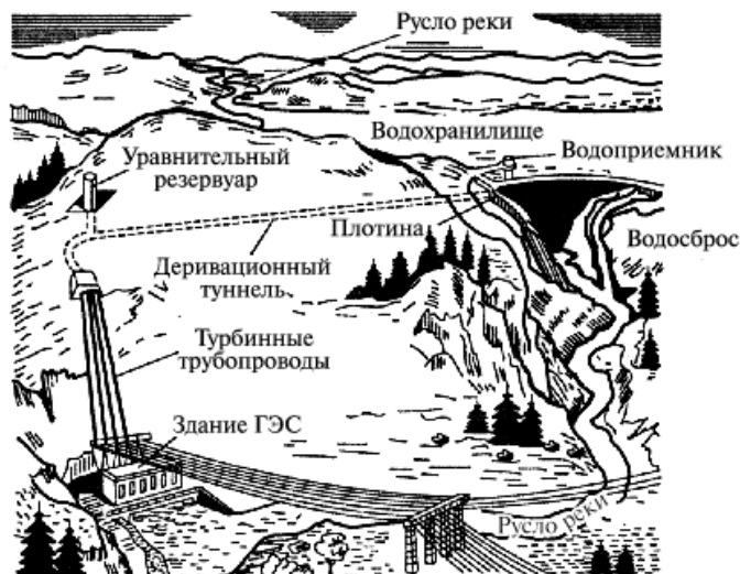
Рис. 5.3. Общий вид деривационной ГЭС: а — с безнапорной деривацией; б — с напорной деривацией
